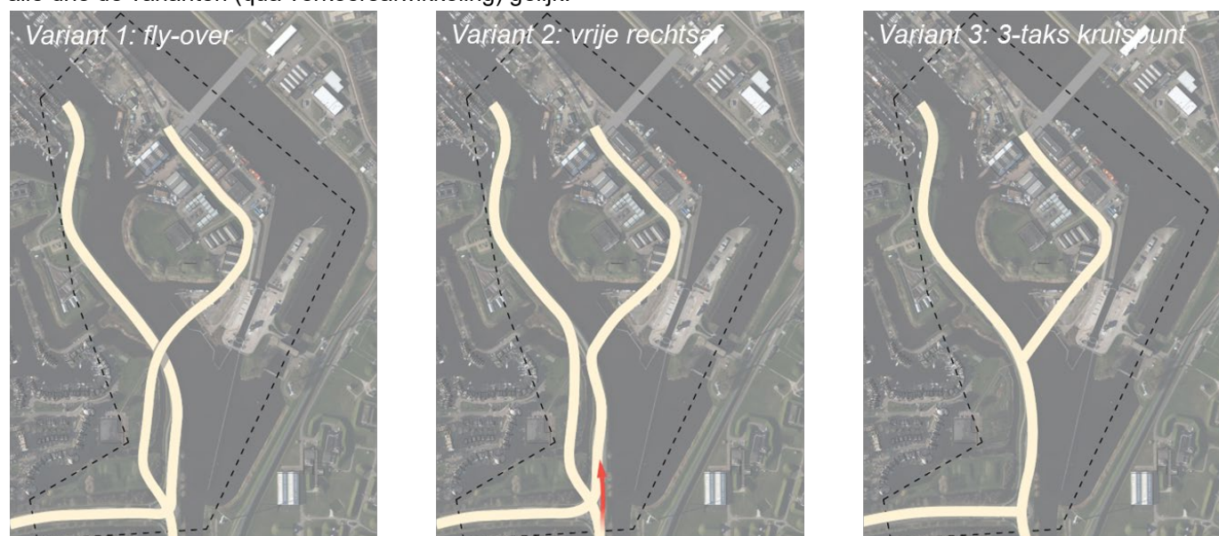
Figuur 3-7 netwerkvarianten (figuur geeft toelichting op het principe, de locatie van nieuwe brug is indicatief)
