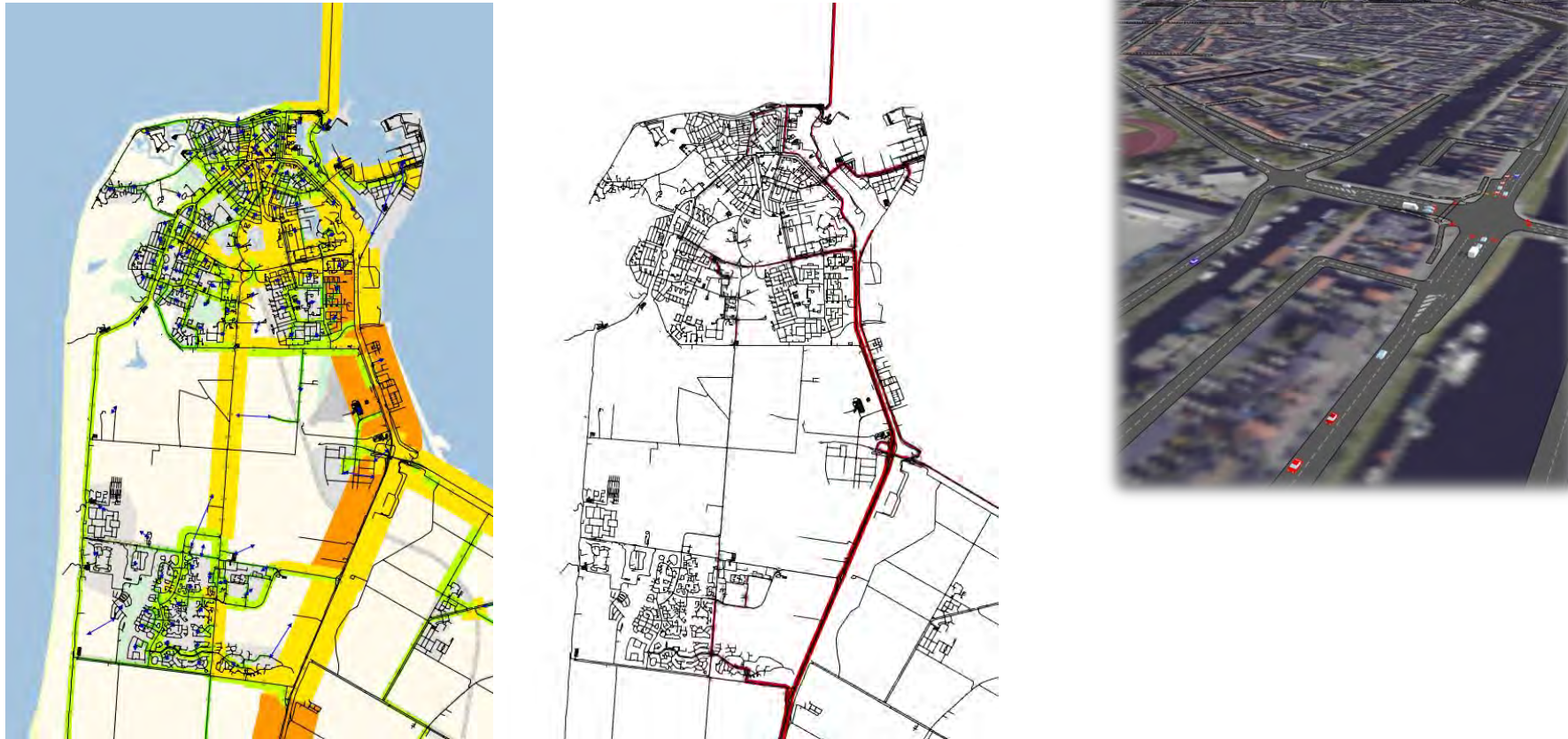
Figuur 40: 'Links': Illustratie de verkeersintensiteiten in het verkeersmodel, 'midden' geeft de verkeersgroei in het verkeersmodel – 'rechts' een beeld uit de microsимулатie.
